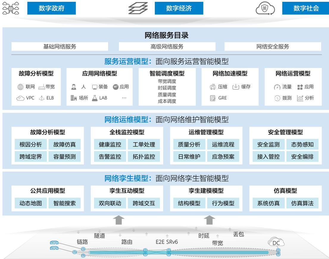
图 3-6：城市网络智能模型层次架构
